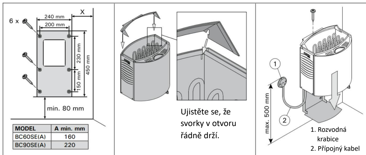
Obrázek 6. Připevnění topidla na zeď
